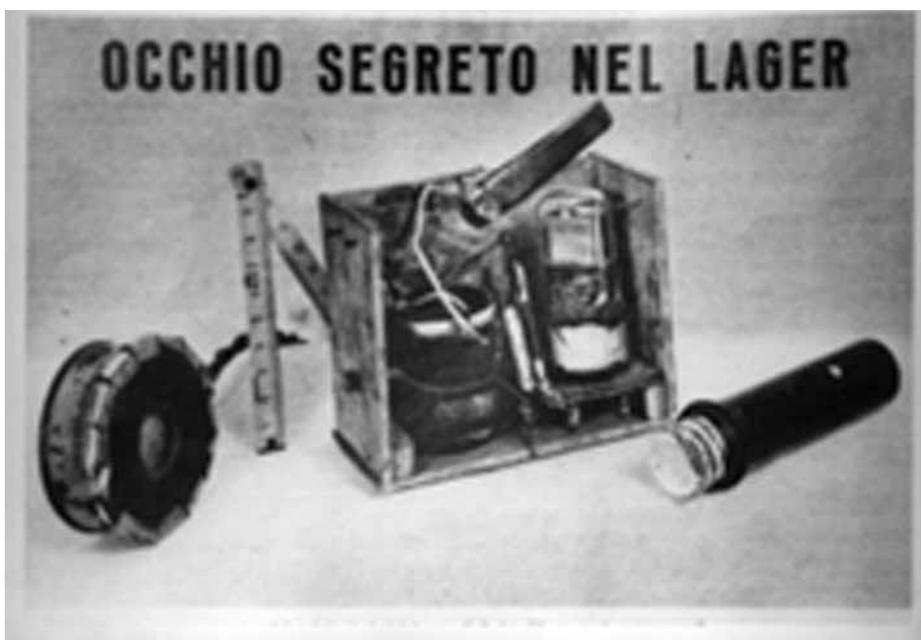
lager fu un tubo elettronico. La valvola era una 1Q5, un tetrodo il cui filamento richiedeva una tensione di 1,5 volt in corrente continua, mentre gli altri elettrodi esigevano una tensione di 9 volt sempre in continua. La valvola aveva funzione di rivelatrice, oscillatrice e amplificatrice per la cuffia.
